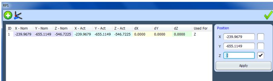
La figure ci-dessous montre l'écran après l'appui sur Apply. Z-nom donne les valeurs nominales. A droite on voit pour quels axes l'entité est utilisée.
