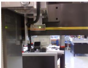
On trouve sur certaines machines des têtes de lecture et des règles en verre Aberlink. Il faut, pour les nettoyer, utiliser de l'alcool et essuyer les règles doucement. Pour un deuxième nettoyage, utilisez un coton-tige neuf ou un chiffon propre.
