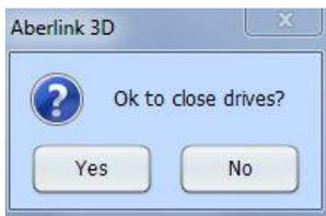
Cliquez sur Yes/Oui, pour activer les transmissions. On peut maintenant déplacer la machine avec le joystick.
